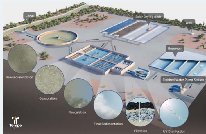
Figura 2: El proceso de tratamiento de aguas de superficie implica eliminar sólidos y contaminantes del agua que ingresa a la planta de tratamiento y desinfectar el agua antes de enviarla a los clientes. Visita tempe.gov/operations para explorar el proceso.
